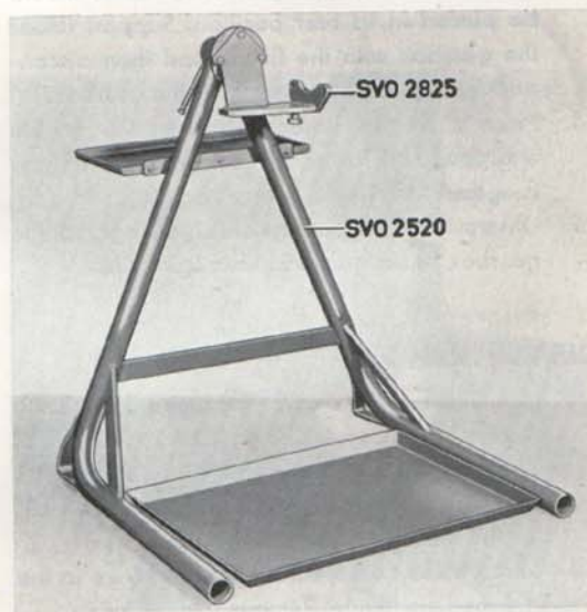
Fig. 4—2. Stand SVO 2520 and fixture SVO 2825
